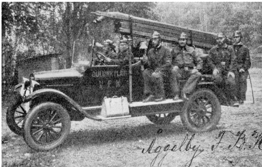
Oulunkylän VPK:n Chevrolet, joka oli hyvin paljon samannäköinen kuin Pukinmäen T-Ford. Yhteisiä tunnusmerkkejä olivat avohyttisen korin lisäksi mm. tikkaiden asettelu ja kolmen henkilön istuttavat penkit sivuilla. Kuva: Oulunkylän VPK.
